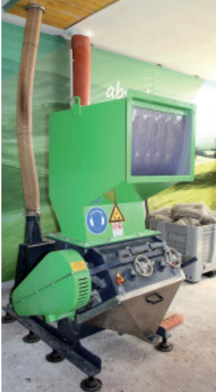
Von der Schneidmühle gelangt das zerkleinerte Material in den Bunker. ↴
