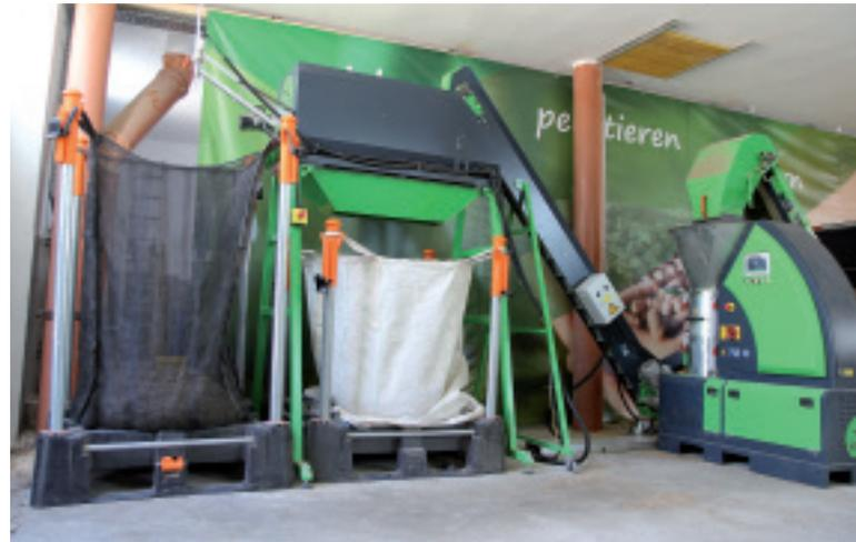
Verbrennen wird eher fest und kompakt gepresst.“ Der Durchsatz liegt – je nach Material – zwischen 200 kg und 1.200 kg pro Stunde. Bei Heu-Mischungen schafft man den beiden Jungunternehmern zufolge ca. 600 kg. Vom Auswurf der Presse werden die
