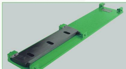
Die Justierung aller Messer erfolgt außerhalb der Schneidmühle in einer Einstelllehre, die zum Lieferumfang gehört. Dadurch entfallen lästige Einstellarbeiten innerhalb der Maschine.
