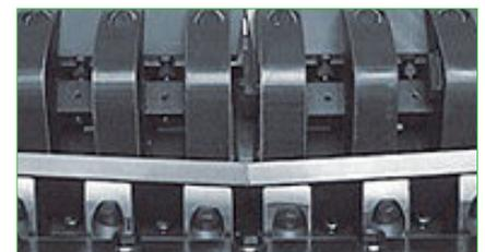
Die Mühlen der Schneidmühle können je nach Aufgabenstellung mit verschiedenen Rotortypen ausgestattet werden. Die Rotormesser sind nach neuester V-Schnitt-Technologie angeordnet, die stets für ein hochwertiges Mahlgut sorgt.
