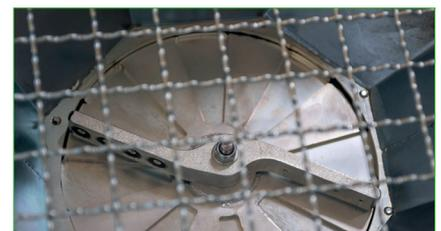
Der im Materialtrichter befindliche Mischer verhindert eine mögliche „Brückenbildung“ von sehr leichten Materialien. Des Weiteren sind am Mischer starke Magneten integriert, die mögliche Fremdkörper wie Nägel oder Metallspäne größtenteils aussortieren können.
