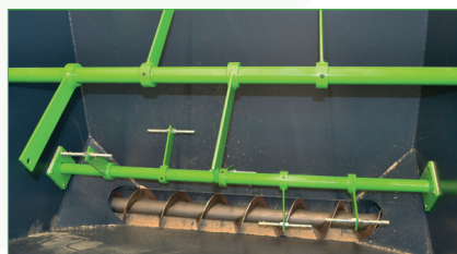
Integriertes Rührwerk zur Vermeidung von Brückenbildung bei sehr leichtem Material
